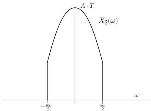
Al muestrear la señal, la transformada de Fourier se multiplicará por  $T$  y se replicará en todos los múltiplos enteros de la frecuencia de muestreo:
