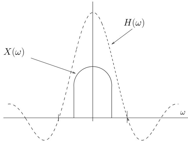
Dado que el primer cero de la sinc está en  $\omega = \omega_s$ , y que la frecuencia máxima de  $X(\omega)$  es  $\omega_s/2$ ,  $X_2(\omega)$  tomará valores en la misma banda que  $X(\omega)$ . Podemos aproximar su forma:
