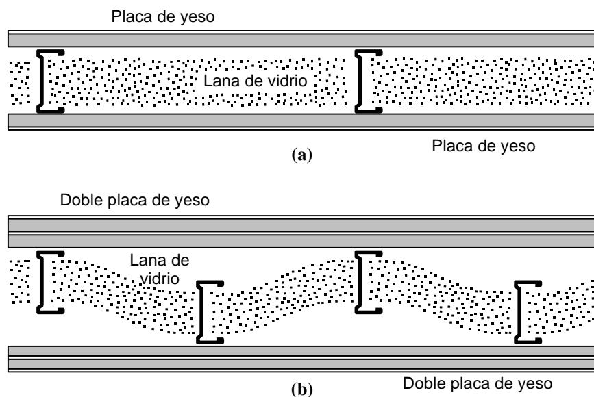
**Figura 4.5.** (a) Vista superior en corte de un montaje de placas de roca de yeso con estructura formada por perfiles de chapa. (b) Estructura alternada sin conexión rígida. Notar la diferencia de espesores a uno y otro lado de la pared.
