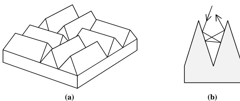
**Figura 4.4.** (a) Una muestra de material absorbente a base de espumas poliuretánicas con terminación superficial en cuñas anecoicas. (b) Mecanismo por el cual las cuñas anecoicas logran gran absorción sonora.
